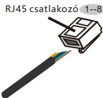
4.36 Ábra: Szigetelő réteg levágása és csatlakoztatása az RJ45 csatlakozóhoz
